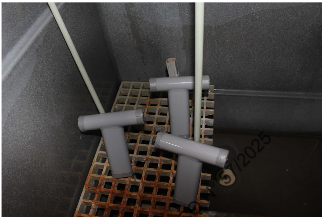
Disposição da amostra na câmara de ensaio.
